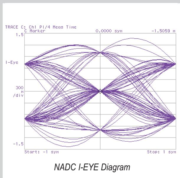
**NADC ( $\pi/4$  DQPSK, 24.3 kS/s, 875 MHz, 0 dBm)**
